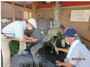
メスシリンダーを使って 湧水量の測定
